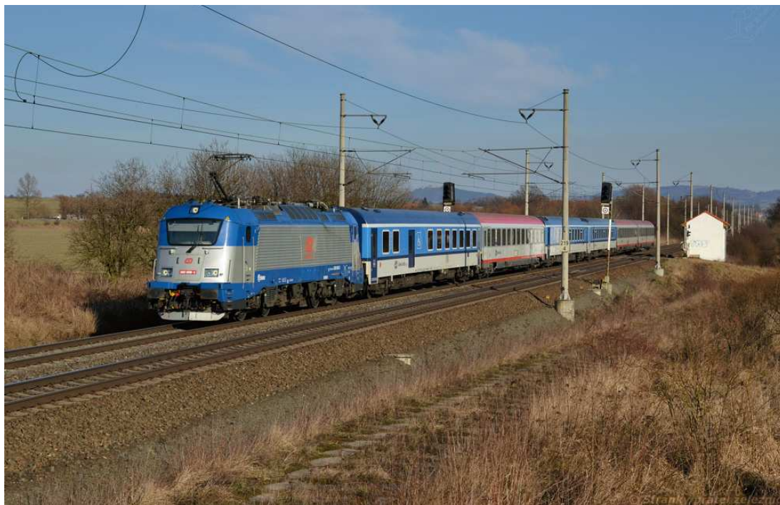
Obr. 3.4-1: Vlaková souprava řazená z vozů řad Ampz 146 , Ampz 143 , Bmz 245 , Bmz 241 a WRmz 815 tažená lokomotivou řady 380
